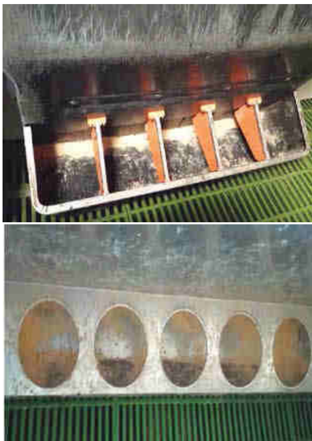
IMÁGEN 2 Y 3 Ejemplos de tolvas en transición bien reguladas.
