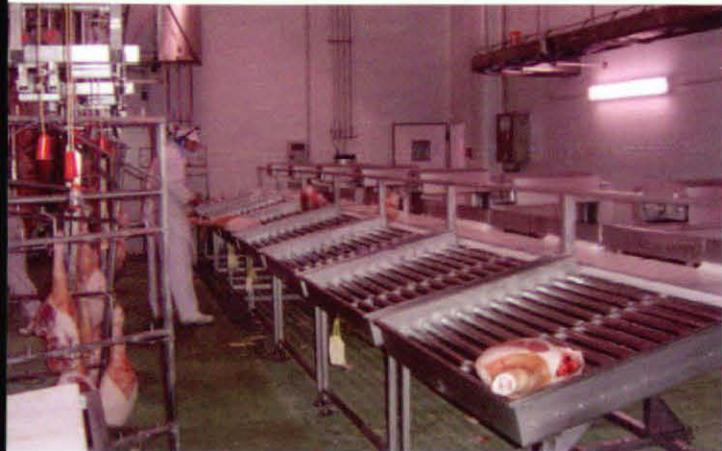
Figura 25.- Tras el perfilado del jamón, se procede a su pesado y a su clasificación por tamaños, de manera mecanizada.
