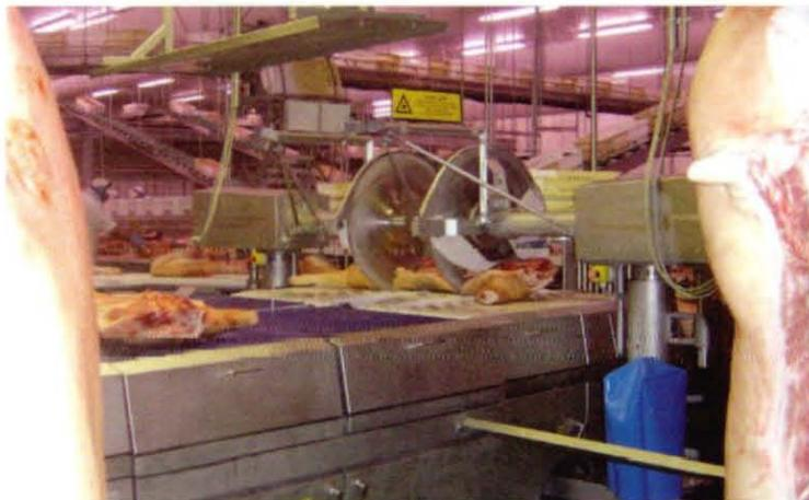
Figura 23.- El jamón y la paleta se separan de forma automatizada del cuerpo central de la canal, para evitar la manipulación.
