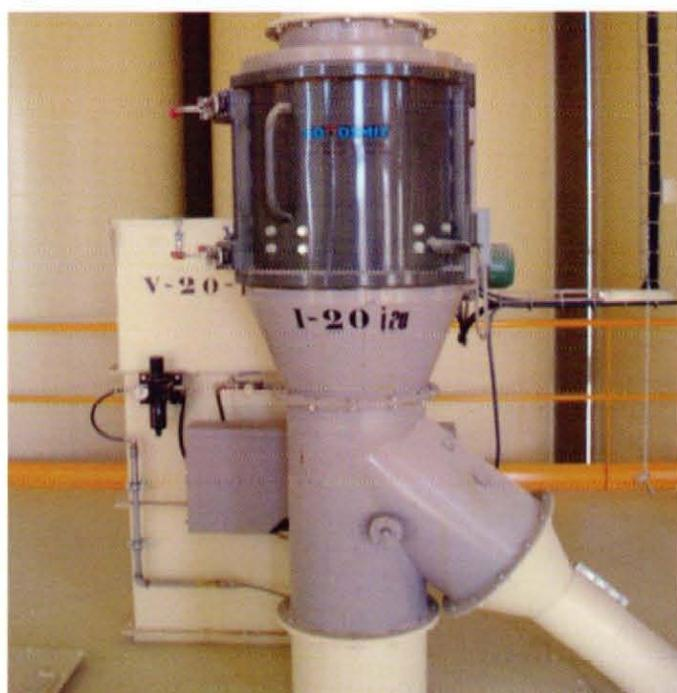
Figura 9.- Maquinaria para la adición de ácidos en piqueta
