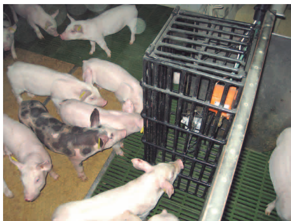
Figura 2. Sensores de NH 3 , temperatura y humedad y CO 2 instalados en la zona animal con su protección.
