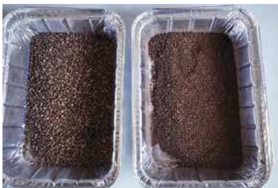
Imagen 2. Muestras de alperujo parcialmente desecado antes (izq.) y después (der.) de ser tamizado.
